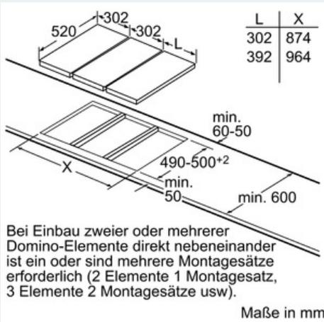
Bild zur Tabelle Domino-Kombinationsmöglichkeiten mit entsprechenden Geräte- und Ausschnittmaßen
