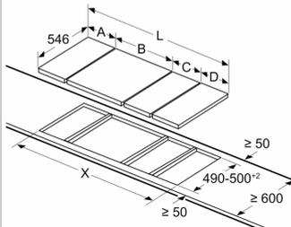
Bei der Side-by-Side-Montage von zwei oder mehreren Elementen sind ein oder mehrere Montagesets erforderlich (2 Elemente = 1 Montageset; 3 Elemente = 2 Montagesets usw.).
