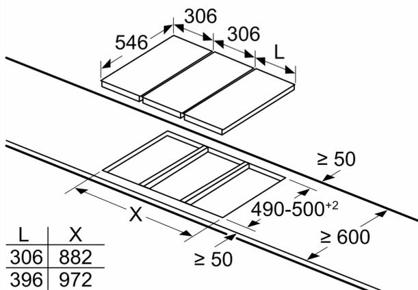
Bei der Montage von zwei oder mehreren Domino-Elementen sind ein oder mehrere Montagesets erforderlich (2 Elemente = 1 Montageset; 3 Elemente = 2 Montagesets usw.).
