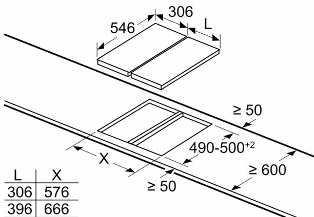
Bei der Montage von zwei oder mehreren Domino-Elementen nebeneinander sind ein oder mehrere Montagesets erforderlich (2 Elemente = 1 Montageset; 3 Elemente = 2 Montagesets usw.).
